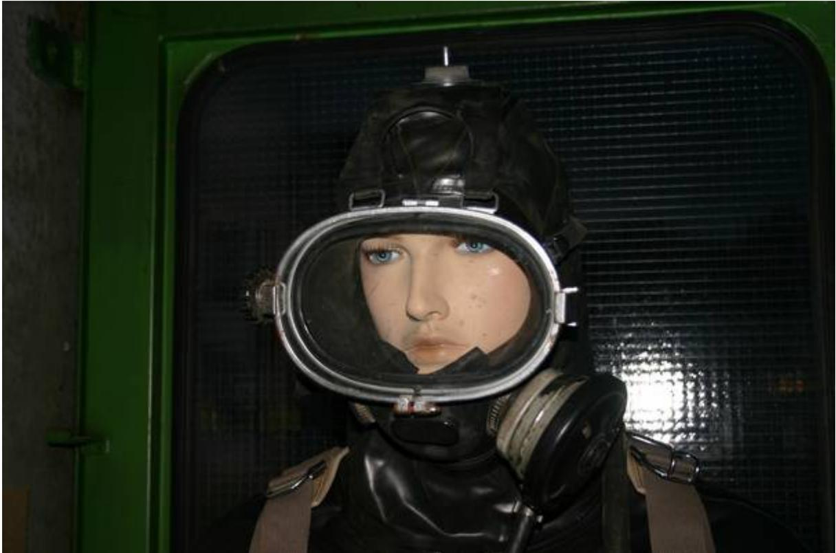
*Taucher mit Konstantvolumenanzug und Dräger Leichttauchgerät PL 70 mit Schlauchversorgung*
