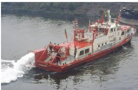
Leichtschaumgenerator des FLB in Betrieb
