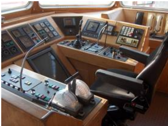
...und der neue, ergonomisch gestaltete Fahrstand mit integriertem Radarschirm
