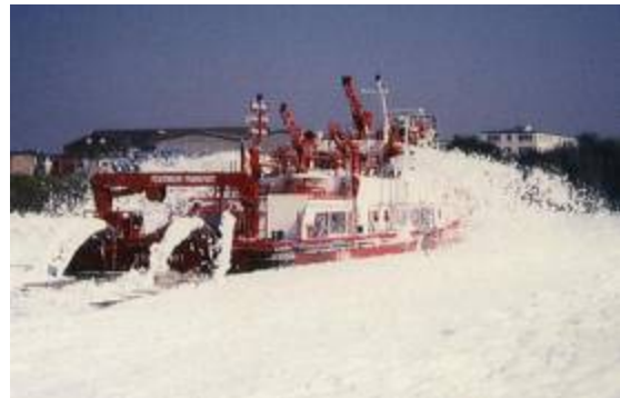
Nach dem Umbau sorgen Mittelschaumrohre für einen gleichmäßigen, dichten Schaum
