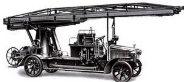
Wasserhydraulische Leiter auf Adler-Fahrgestell
