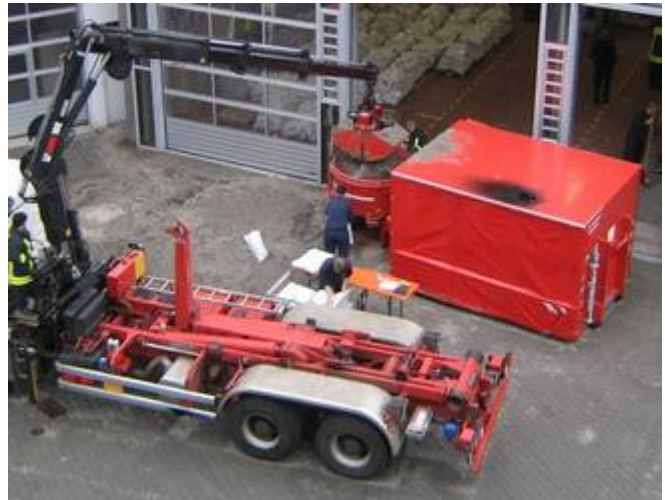
AB-Sandsackfüllmaschine im Einsatz
