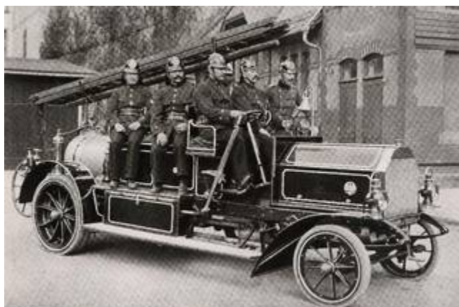
Benzingetriebene Gasspritze im Hof der Feuerwache Burgstraße
