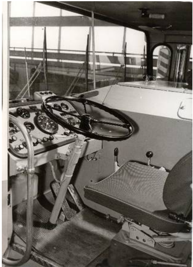
Blick in die Fahrerkabine des GTLF 18. Im Kasten zwischen den Sitzen befindet sich der 500 PS-Motor
