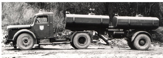
Tanksattelzug mit 2 x 2.500 l Wasservorrat
