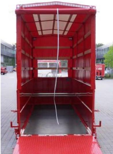
Für Transportaufgaben wurde im Jahr 2006 ein AB-Ladeboden der Firma Ruthmann beschafft. Der Ladeboden hat innen eine nutzbare Flächen von 4,50 x 1,74 m und eine nutzbare Höhe von 3 m. Der Ladeboden ist mit Spriegel und Plane ausgerüstet. Im Inneren befinden sich Sicherungsstangen und Zurrgurte zur Ladungssicherung. Die Ladeklappe am Heck kann mit Gabelstaplern befahren werden. Der Ladeboden kann mit beiden Ruthmann-WLF der Frankfurter Feuerwehr transportiert werden.
