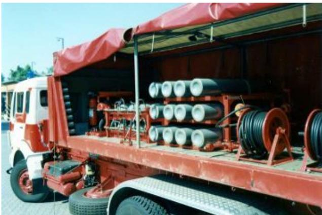
Abrollbehälter mit CO<sup>2</sup>-Löschanlage von Minimax
