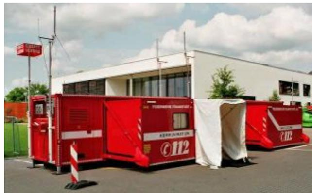
Die Arbeitsräume der beiden Abrollbehälter lassen sich durch ein Zwischenzelt zu einer Einheit verbinden
