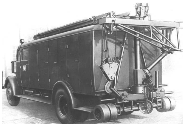
Faltkran des Rüstwagens in Fahrstellung
