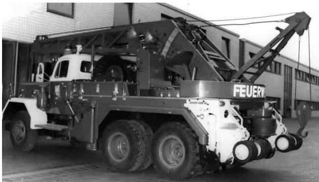
Abklappbare Abschleppvorrichtung am Heck. Lasten bis 5 t konnten auch ohne Stützrollen verfahren werden
