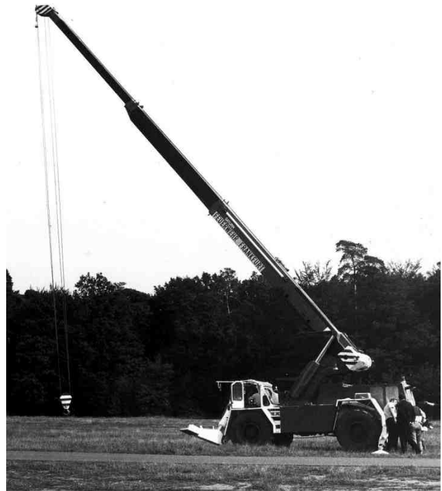
Anheben der Pratzen bei austeleskopiertem Hebebaum
