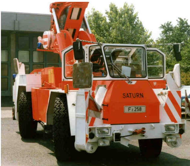
Der Dritte im Bunde: Kranwagen Saturn 26F. Auf dem Foto gut erkennbar: Aufrichten des Hebebaumes ohne Abstützung und seitliches Versetzen („Hündchengang“)
