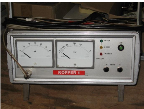
„Erdschluss-Messgerät“. Eine der zahlreichen Eigenentwicklungen des Sachgebietes. Das Gerät befindet sich heute im Museum der Frankfurter Feuerwehr
