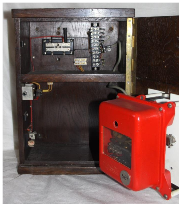
Geöffneter „Holzkasten-Melder“ mit Laufwerk (rot), Türkontakt, Blitzplatte (oben links) und elektrischen Anschlüssen
