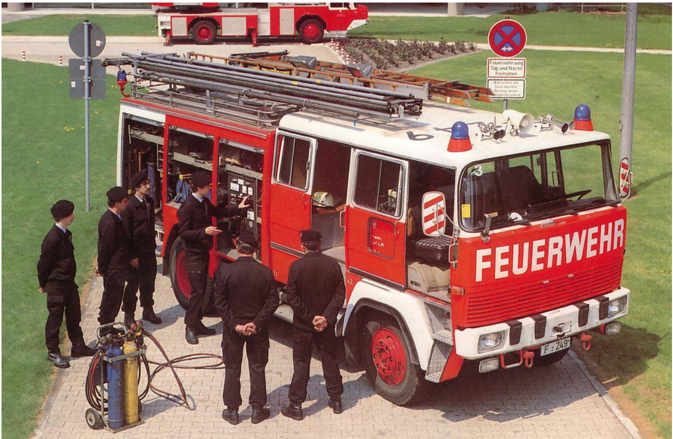
Versuchsweise wurden in den 1970er Jahren verschiedene Fahrzeuge (HLF, TROWA, GB) mit Baumgartner-Schiebetüren ausgestattet. Hier eins von zwei „Schiebetüren-HLF“
