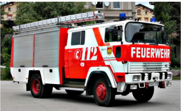
Magirus Deutz FM 192 D 11 FA, Aufbau Rosenbauer Baujahr 1982, bei der FF Diez-Freindiez
