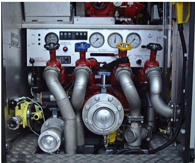
Pumpenraum des Dennis „Rapier“ mit Godiva FP 30
