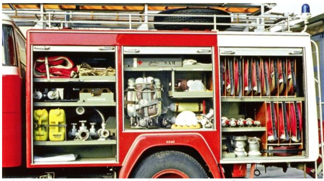
Linke Fahrzeugseite: Brandbekämpfungsgesät. Bei späteren Umbauten werden die Atemschutzgeräte aus dem so genannten „Karussell“ im Aufbau direkt in die Mannschaftskabine hinein verlagert
