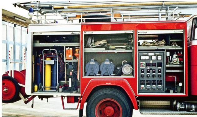
Rechte Fahrzeugseite: Hilfeleistungsgerät und Generator-Bedienstand. Das große Autogenschneidergerät wird bei späteren Umbauten durch ein kleineres ersetzt und die Beladung ab 1977 durch ein hydraulisches Rettungsgerät ergänzt
