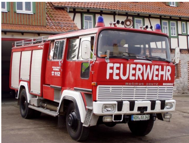
Magirus Deutz FM 170 D 11 FA, Aufbau Magirus, Baujahr 1972 bei der Freiwilligen Feuerwehr Buchholz in der Nordheide.
