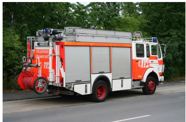
Heckansicht mit Lichtmast und Fahrhaspel
