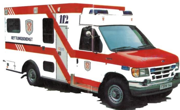
Rettungswagen der RBE auf Fahrgestell Ford E 350 mit Aluminium-Aufbau von EMS. Der 7,3 Liter-Dieselmotor hat eine Leistung von 168 PS 11
