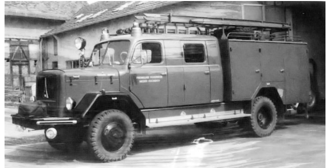
Magirus Deutz 150 D 10 A Löschgruppenfahrzeug LF 16 der FF Nieder-Eschbach, noch in Rot/Schwarz
