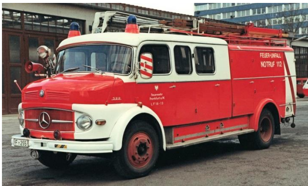
Mercedes Benz LAF 1113 Löschgruppenfahrzeug LF 16 mit Bachert-Aufbau. Eine Besonderheit sind die drei seitlichen Kabinenfenster.
