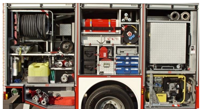
Beladung rechte Fahrzeugseite; Multifunktionscontainer im Geräteraum G2 (rechts)
