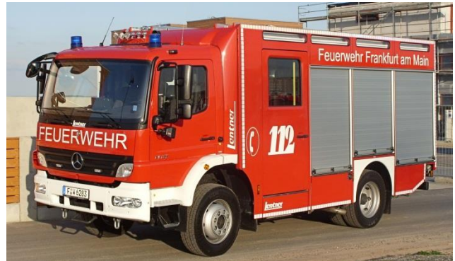
DB „Atego“ LF 10/6 der FF Heddernheim mit Aufbau von Lentner
