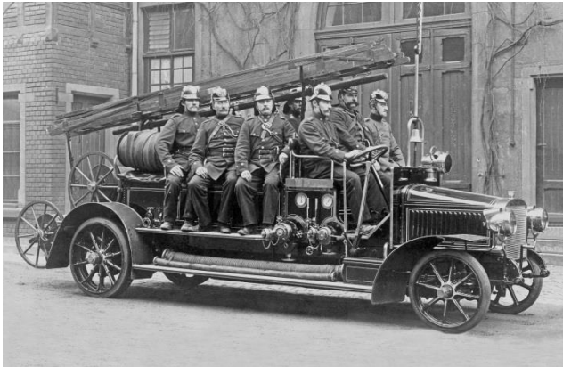
Adler Motorspitze der BF Frankfurt, Baujahr 1911. Das Fahrzeug unterscheidet sich von seinem Vorgänger von 1910 vor allem durch die weiter nach oben gelegten Pumpenanschlüsse.
