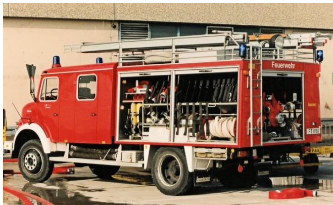
LF 16-TS der FF Sindlingen auf Mercedes Benz LAF 1113-Fahrgestell mit Aufbau von Lentner
