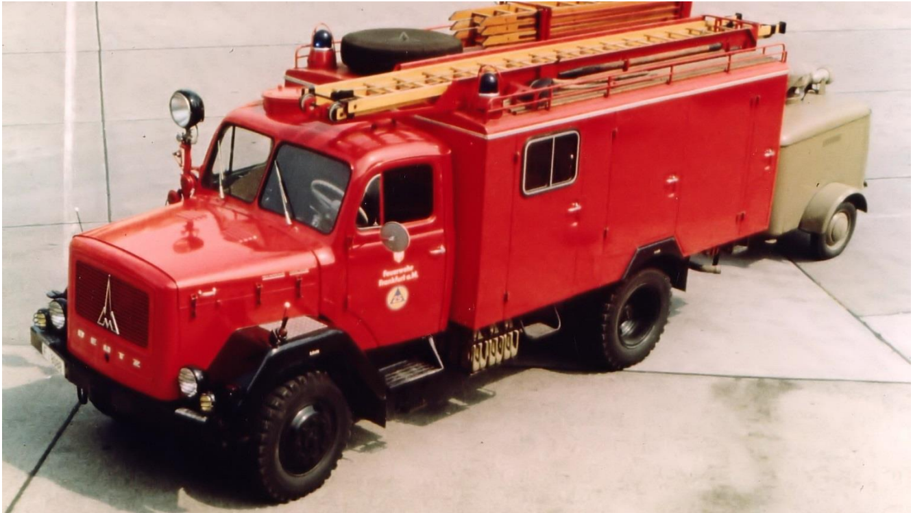
LF 16-TS von Magirus, hier mit Sirenenanhänger („khakigrau“ war die ursprüngliche Farbgebung des KatS)
