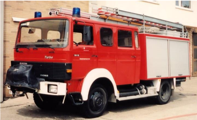
LF 16-TS der FF Enkheim auf Iveco Magirus 90-16 AW-Fahrgestell, Aufbau Lentner
