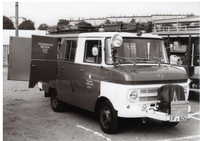
LF 8 auf Fahrgestell Opel Blitz mit Seitenbeladung, Aufbau Magirus, Freiwillige Feuerwehr Enkheim
