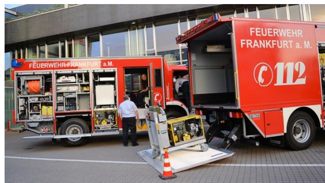
Links ein „normales“ LF 10/6 von Lentner; rechts das LF 10-Logistik mit offenem Heck-Geräteraum
