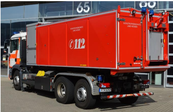
Wechseladerfahrzeug mit Abrollbehälter „Löschwasserversorgung“ (Hytrans Fire System)
