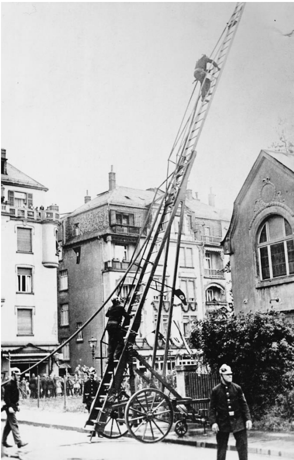
Eine weitere öffentliche Übung im Jahr 1934 an der Ecke Burgfrieden-/Reichsburgstraße (beim Parkrestaurant). Gut erkennbar ist hier die dreirädrige Schiebeleiter von Lieb. Die Hakenkreuzfahne im Hintergrund markiert bereits die neue Zeit.
