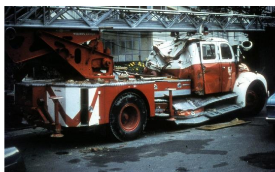
DL 30-6 mit Totalschaden nach der Explosion (hier bereits im Hof der Feuerwache 3)
