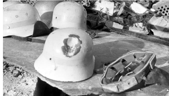
Die Bebänderung wurde aus der Helmschale gerissen
