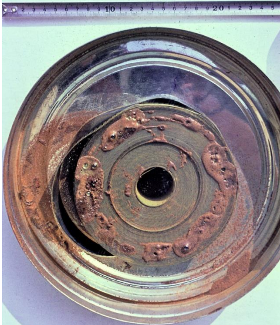
Teile des Films sind erweicht, Ausscheiden einer schleimigen Schicht mit Gasbildung
